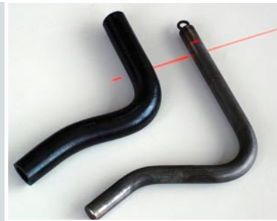
Comparación mandril-manguera: generación gráfica de los datos escaneados y salida simultánea de datos en formato xyz y formato para curvado; corrección de datos según el tipo de máquina dobladora
