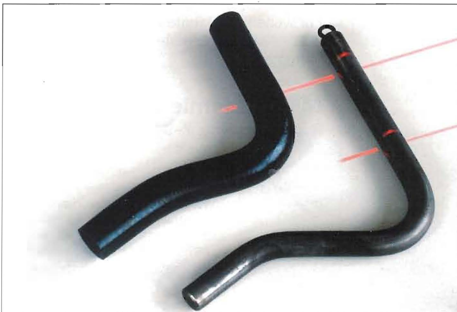
LaserLine Messung: Messwertaufnahme durch Laserstrahlscannen am Anfang und Ende jedes geraden Rohrabschnitts.
