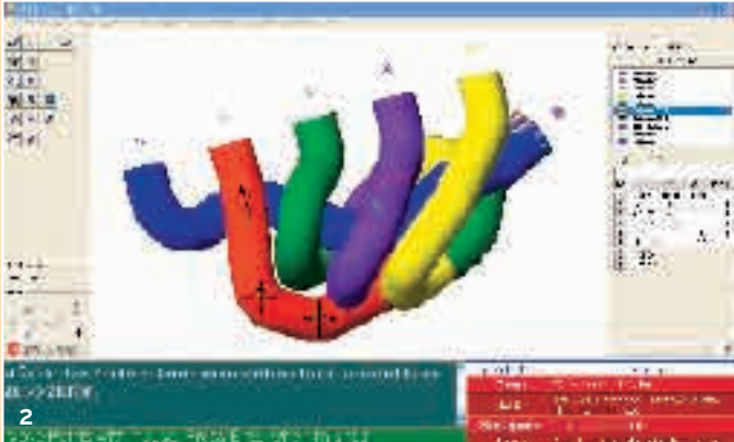
1 _ Klaus Leistritz bei der Vorführung des Laserscanners »MicroScanSilver«. 2 _ Die TezetCAD-Rohrsoftware macht aus den Messdaten Bilder.
