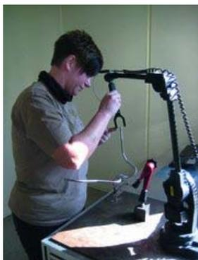
Anka Reitz beim Erfassen der Rohrgeometrie mit dem Messarm.
