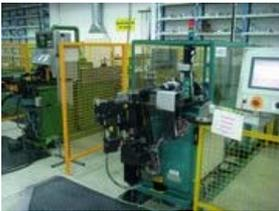
Die Korrekturdaten werden manuell an der Rohrbiegemaschine eingegeben.
