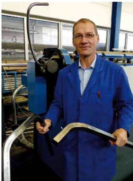
Lothar Kummermehr zeigt, dass die Neu-Freiformbiegemaschinen nicht nur Rundrohre, sondern auch Profilrohre beherrschen.
