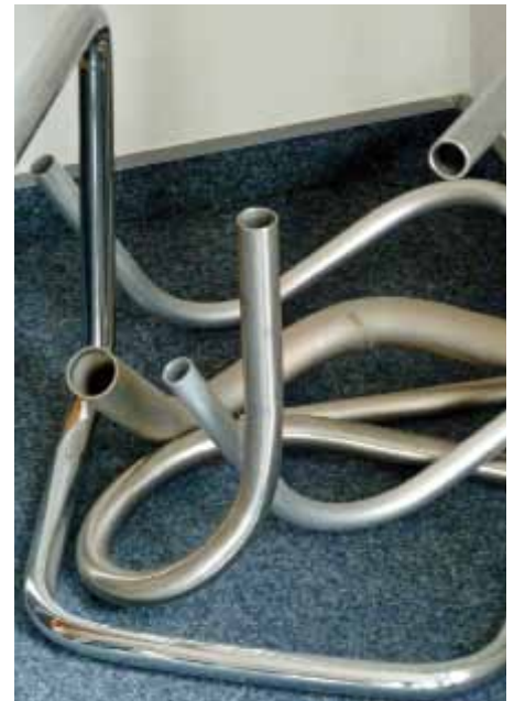
Mit den erfassten oder optimierten Daten, die von der Tezet-Software im Rechner verarbeitet und dokumentiert werden, wird auf einer Sechs-Achs-Freiformbiegeanlage von Neu die endgültige Rohrgeometrie erzeugt.
